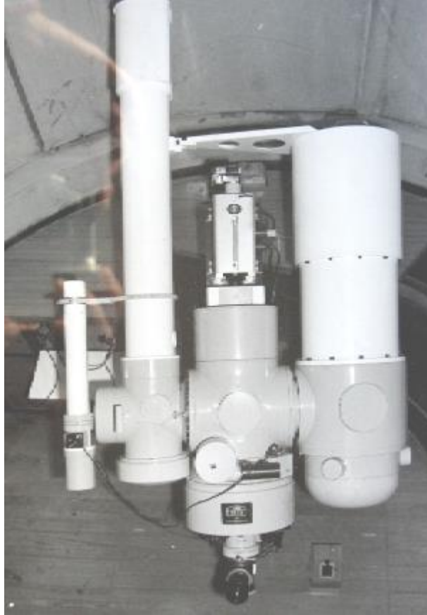
Doblete Zeiss de 30 y 15 cm, respectivamente; con monocromador de Lyot que servía de guía.
