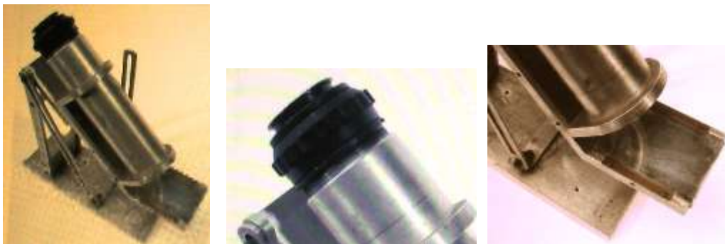
Pequeño telescopio acodado para una cómoda observación cenital, con oculares de gran campo – NASA-SAO Web
