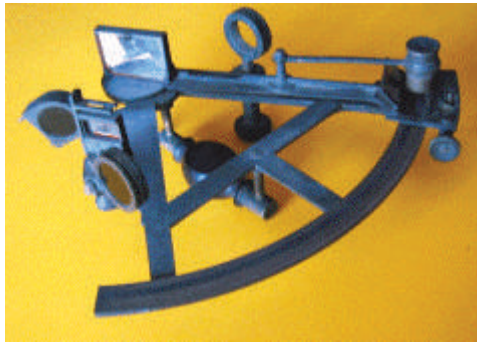
Cuadrante de reflexión y sextante clásico, utilizados en la navegación de altura – Web
